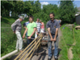
Kabelaring maken bij touwslagerij Deetman
