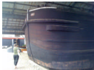
De stroomlijn van dit vrachtschip was onbelangrijk: maximale vulling van de sluis wel
