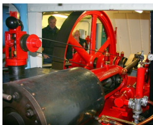
Het indrukwekkende rode vliegwiel van de stoommachine in de baggermolen.
