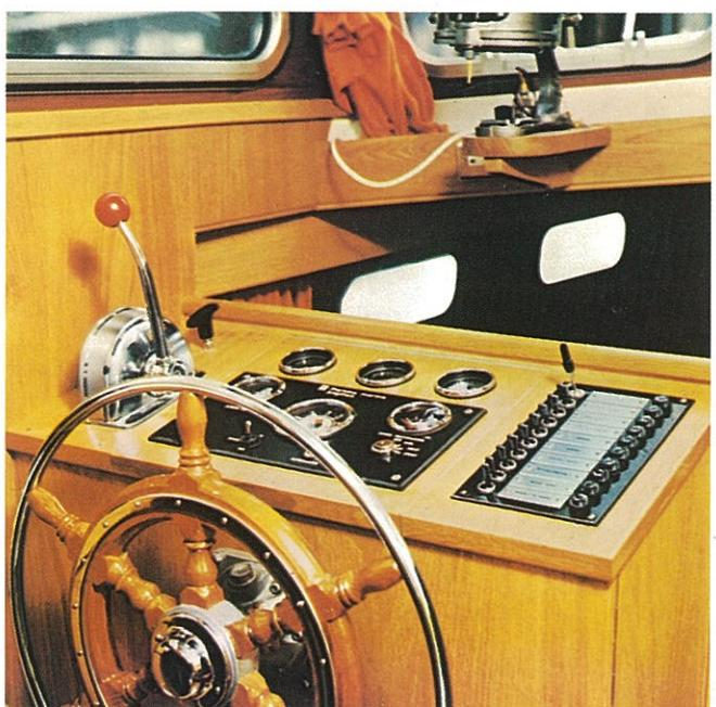
Stuurstand met opklapbaar instrumentenpaneel waarin elektr. verdeel- en aansluitbord. Onder het schakelpaneel een kast waarin het komaliewant zeevast geborgen wordt.
